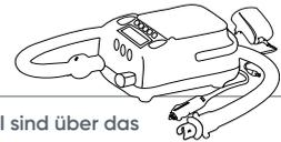
**Bar/PSI sind über das Bedienfeld individuell einstellbar.** Die Pumpe stellt sich bei Erreichen des eingestellten Wertes automatisch ab. Sollte der eingestellte Wert höher als empfohlen sein, lösen die Überdruckventile als Sicherheitsmaßnahme aus. Beim Zuschalten des Kompressors ist eine erhöhte Lautstärke normal.
